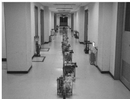
図 3 蛍光灯を用いて廊下を自律走行するロボット
