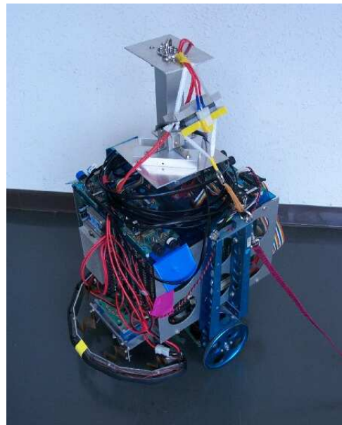
Fig.1 センサと紐を搭載した自律移動ロボット山彦
