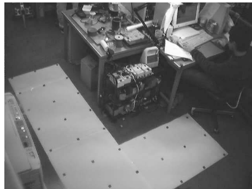
Fig.4 座標変換パラメータ推定に使用するシート
