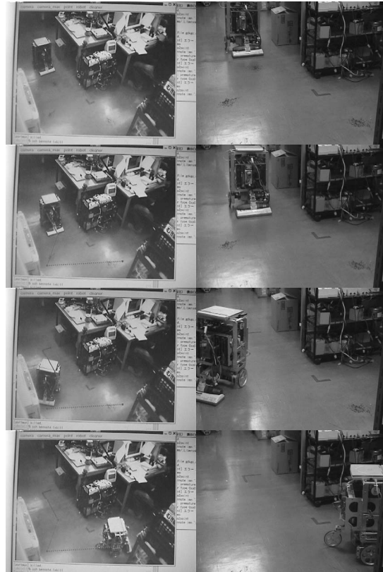
Fig.7 指示経路走行実験 (上から下に時間が経過、左側はディスプレイ上に表示された画像中での動き (点線は指示経路)、右側は実際のロボットの動き)
