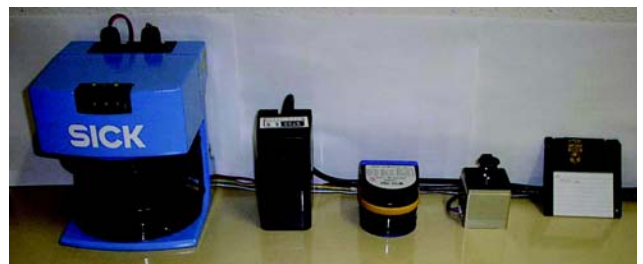
Fig.1 光学式距離センサの概観比較(左から、ジック(株)LMS-200、北陽電機(株)PB9、北陽電機(株)PBS、レンジセンサプロジェクトによる試作機URG-X000、比較のためのフロッピーディスク)
